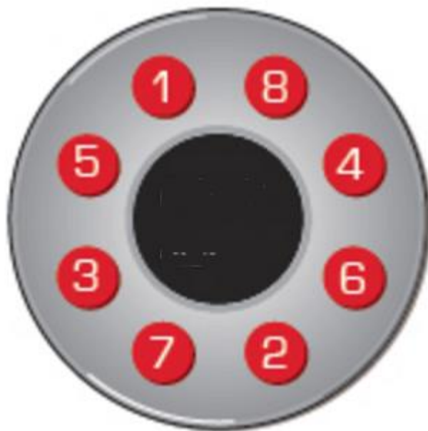
Rys. 11 Kolejność dokręcania śrub (rysunek poglądowy)
